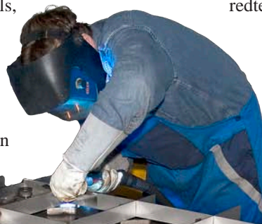
Um der großflächigen Konstruktion Stabilität zu verleihen, werden gitterartige Verstreibungen eingebaut.
