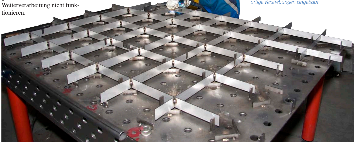
Um der großflächigen Konstruktion Stabilität zu verleihen, werden gitterartige Verstreibungen eingebaut.
