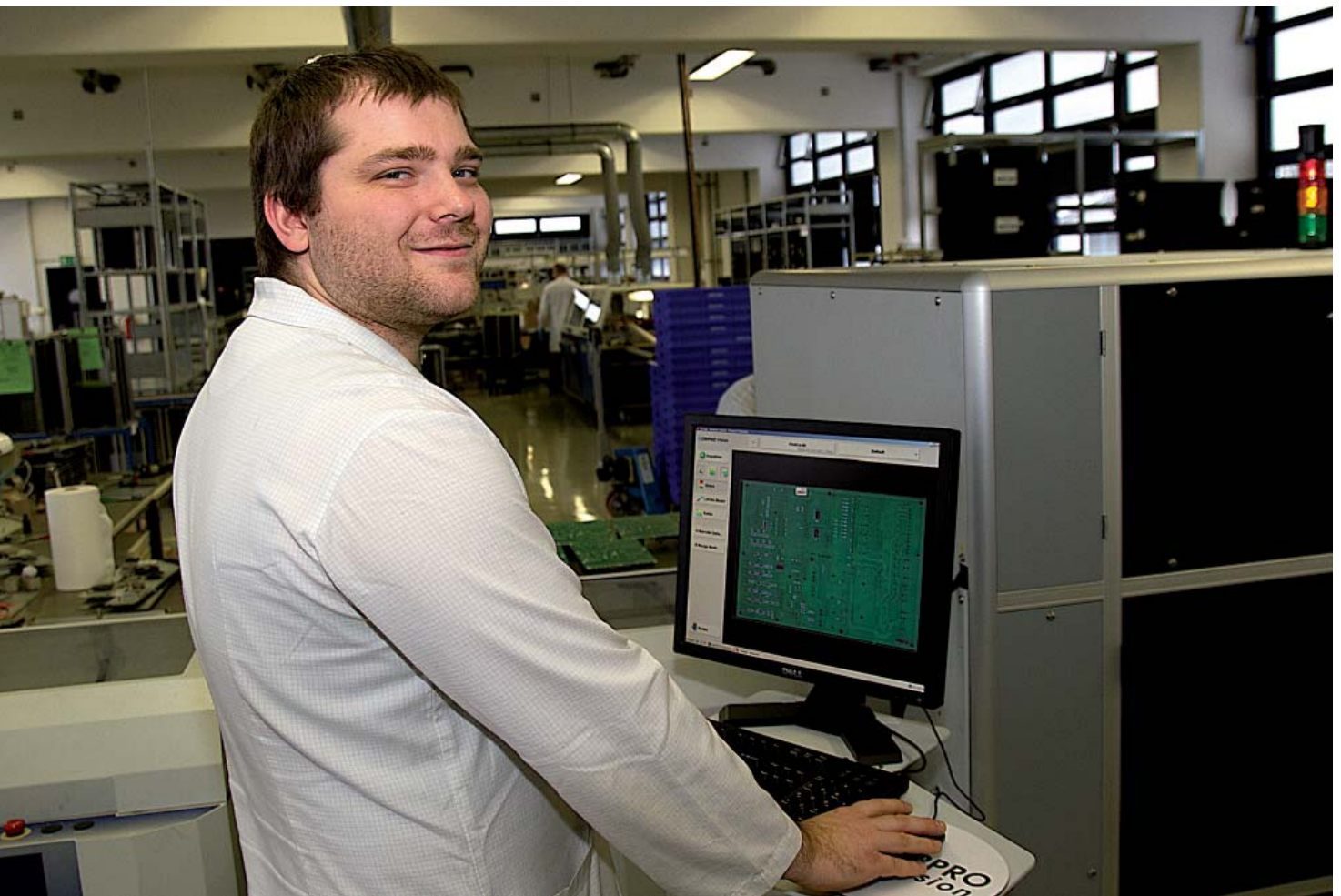
Björn Radeke kontrolliert die Leiterplatten mit einem automatischen optischen Prüfgerät. Fehler werden hier zuverlässiger und in einem Bruchteil der Zeit gefunden.
