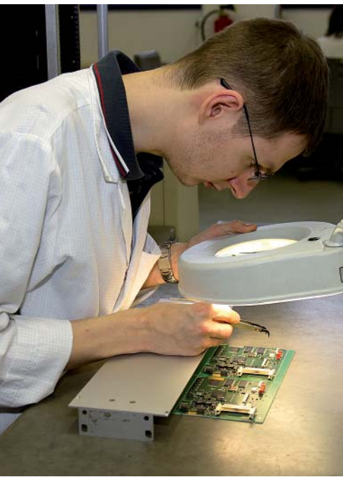
Elektronische Leiterplatten zu prüfen, ist eine mühsame Prüfmethode. Frank Schröder muss sich Lötstelle für Lötstelle ansehen.
