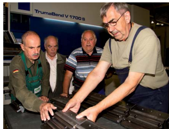
Günter Koch und seine Freunde vom Technikmuseum „Hugo Junkers“ richten eine Vorrichtung zum Biegen von Wellblech ein.
